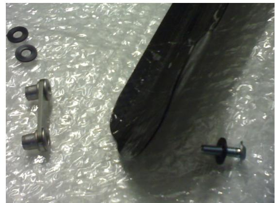
Il conetto filettato serve per fissare i distanziali al puntale: inserire tra la rondella della vite e il carbonio lo spessore di gomma antivibrazione. Evitare di stringere troppo in modo che i distanziali possano ruotare per trovare la corretta posizione;
